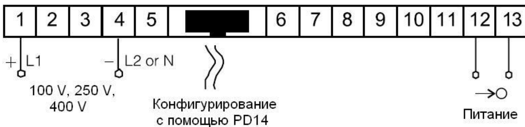
Рис. 6. Схема электрических соединений для приборов N24Z, N24H и N25Z, N25H для измерения напряжения (для измерения частоты - только для приборов N24Z и N25Z)
