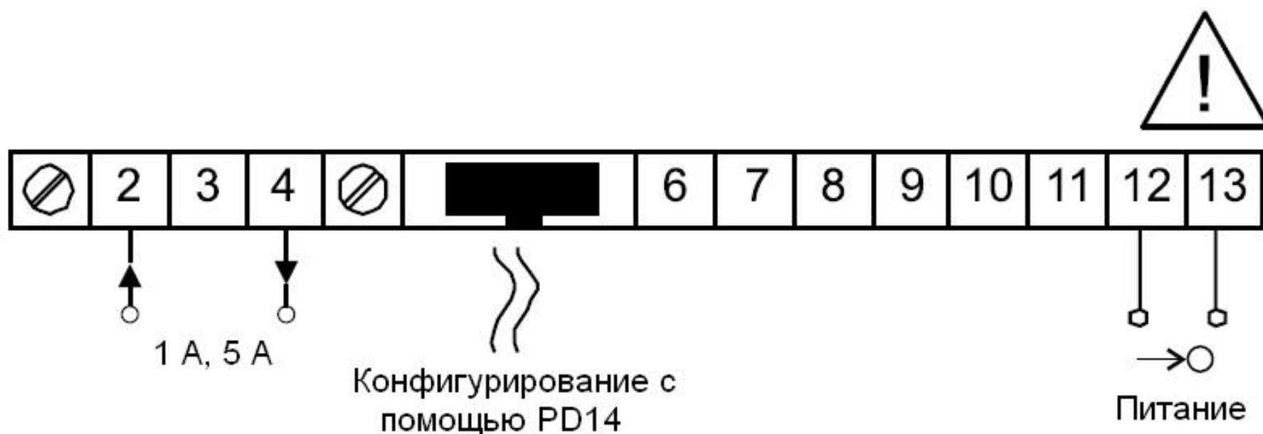
Рис. 7. Схема электрических соединений для приборов N24Z, N25Z и N24H, N25H для измерения тока
